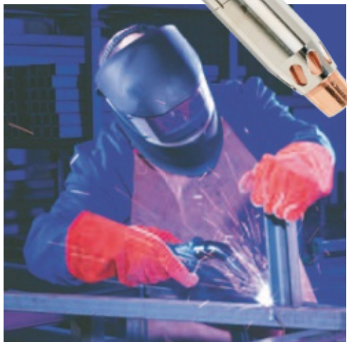
Uchwyt RAB GRIP z włączonym układem odciągania dymów spawalniczych
