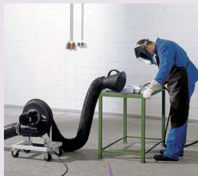
Przykład zastosowania: mobilny wentylator odcigowy
