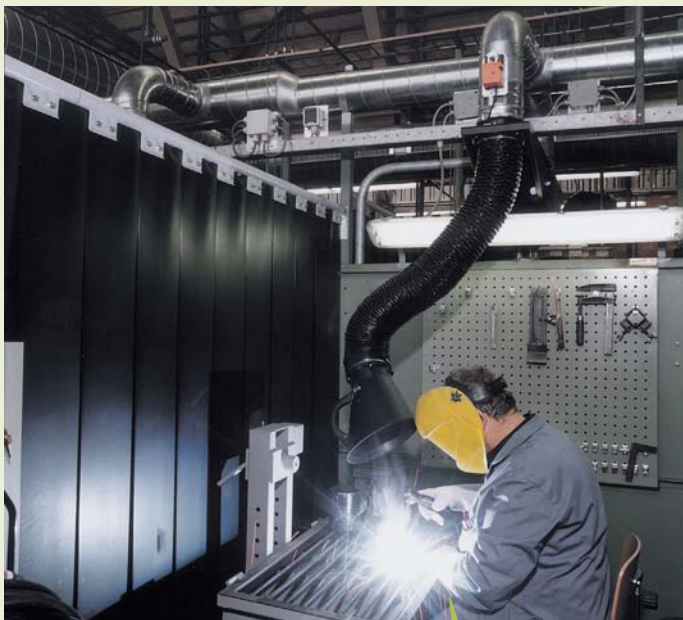
Przykład zastosowania: ramię teleskopowe w kabinie spawalniczej
