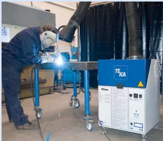
Przykład zastosowania: filtoo z ramieniem odciągowym
